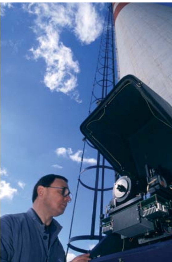
Un technicien effectue un contrôle des émissions des fumées sur une cheminée.
