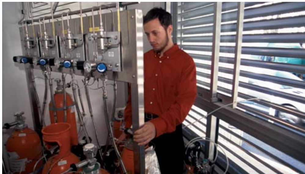
Un technicien procède à l'étalonnage d'instruments de mesure de la qualité de l'air
