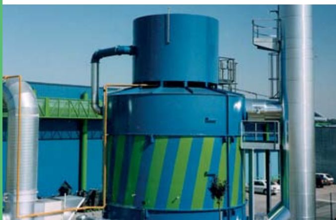
Incinerateur de COV. Réduction des émissions de pollution des sources fixes.
