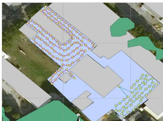
Lorsque l'option est activée, une ligne est tracée entre les points de mesure en suivant leur ordre d'acquisition. L'objectif est de **faciliter la mise en évidence d'éventuels sauts de GPS et de mieux interpréter les valeurs mesurées lorsque les trajectoires se croisent**. Une couleur différente est attribuée pour chaque campagne.
