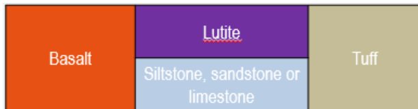
Fig. 2 : Exemple de règle d'assemblage des lithotypes pour les simulations plurigaussiennes
